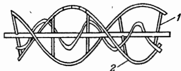
Рис. XX-5. Лопастной вал ленточного смесителя:
