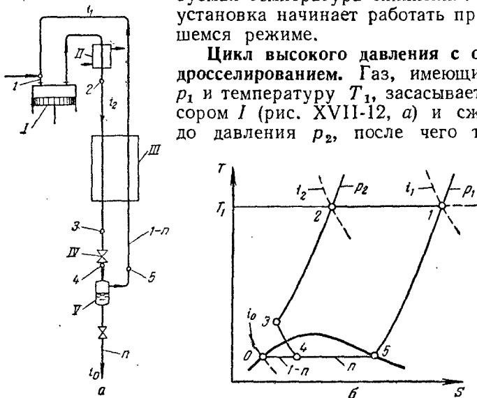
Рис. XVII-12. Регенеративный цикл высокого давления с однократным дросселированием:
